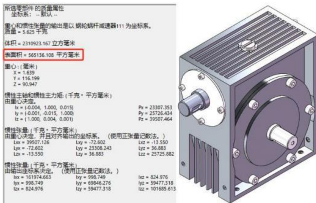
图 3-3 蜗轮蜗杆减速器质量分析结果图
